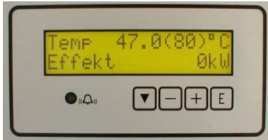
7-trinns elektronisk regulator med mulighet for fjernstyring
