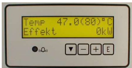
30-trinns elektronisk regulator med mulighet for fjernstyring
